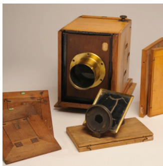
Chambre photographique à tiroir pour la daguerréotypie dite "Daguerréotype de voyage" avec ses accessoires.
